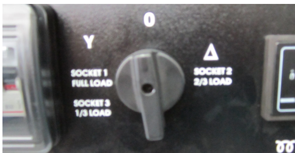
Abb. 15.1: Sternschaltung (rechts) / Dreieckschaltung (links)
